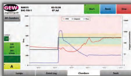
OxyGuard monitora e mantiene automaticamente il livello di ossigeno in base al punto di regolazione del cliente, garantendo la massima efficienza.
