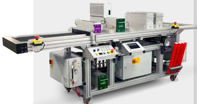
**Exciray può essere incorporato in una unità di laboratorio GEW personalizzabile con trasportatore per applicazioni di controllo della qualità e ricerca e sviluppo.**
